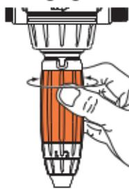
Le réglage du dosage s'effectue en faisant correspondre l'ailette de la bague de réglage à la graduation souhaitée sur la règlette. La quantité de produit injectée est proportionnelle à la quantité d'eau qui entre dans le Dosatron :
